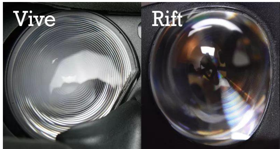
图：HTC Vive和Oculus Rift中的菲涅尔透镜
